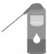
Um den Effekt von korrosiven Materialien auf Ihr Produkt zu minimieren, reinigen und trocknen Sie Ihren Streuer nach jedem Gebrauch gründlich. Zusätzlich sprühen Sie als vorbeugende Maßnahme alle Metall-Teile mit einem Leichtöl oder Silikon-Spray ein.
